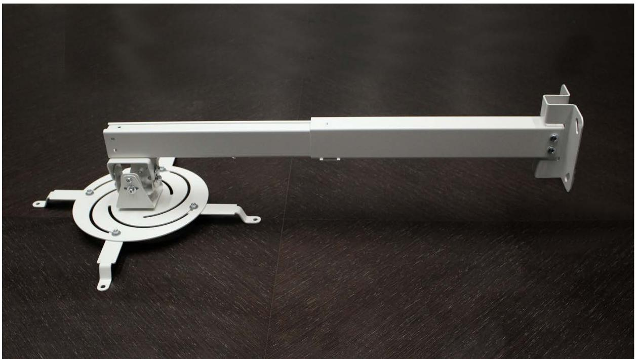
В отличие от прототипа, при настенном креплении не применяются переходники. Крепление узла наклона и поворота проектора производится непосредственно к штанге. Опять-таки повышается надёжность крепления.
